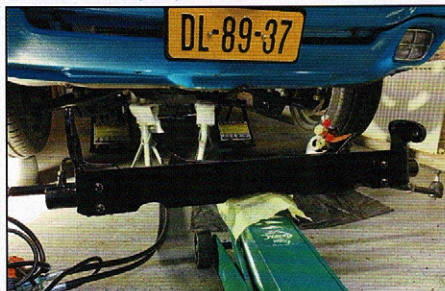
De hele stuurinstallatie op de krik
