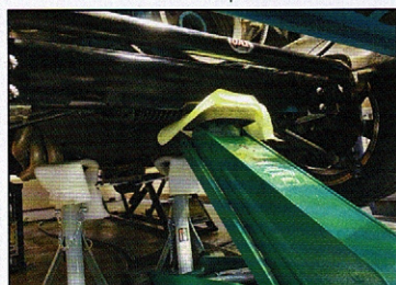
Stuurinstallatie tussen het subframe
