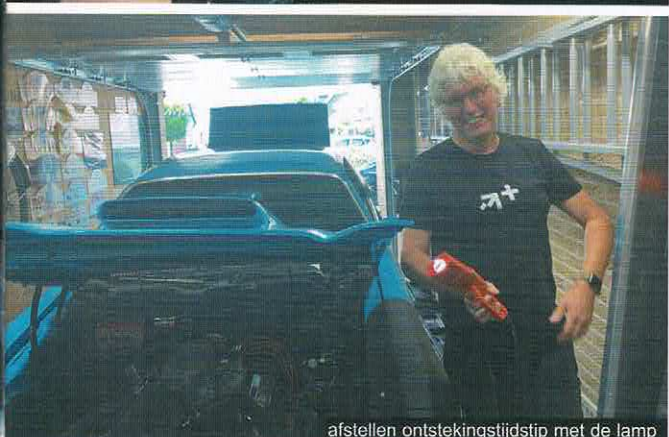
afstellen ontstekingstijdstip met de lamp
